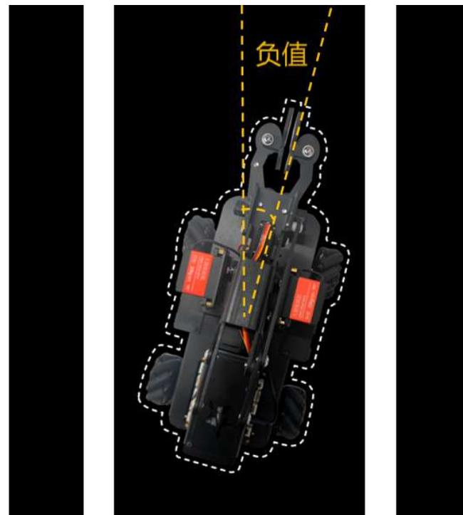
**注意：偏离量越大，两侧电机转速差值需要越大，否则智能车模型无法修正偏离量**
